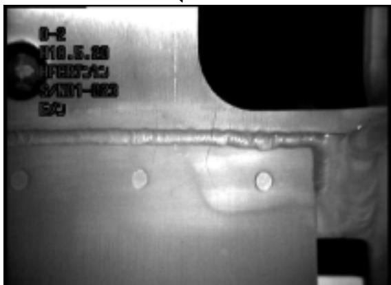
ひびの長さ : 右 約 1.5 cm : 左 約 1.5 cm
