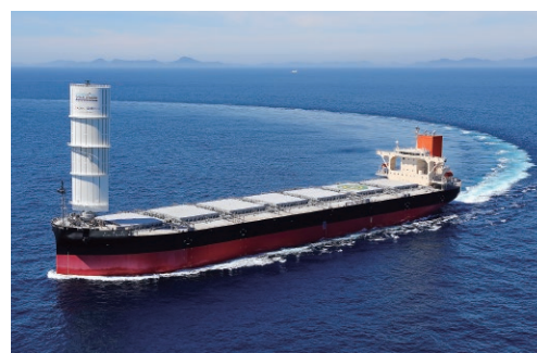
風力エネルギーを船の推進力に変換する装置を搭載した石炭輸送船「松風丸」
