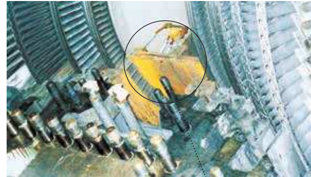
蒸気タービン第1段ノズル 付着防止 First stage turbine nozzle scale prevention
