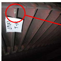
矢視A：磨耗① 接触状況（低圧タービン動翼）
