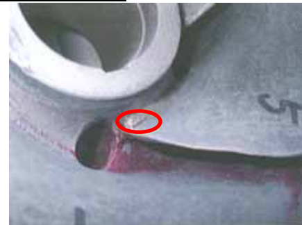
当該ポンプ羽根車指示模様状況写真
