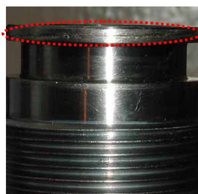
傷状況図(弁蓋)
