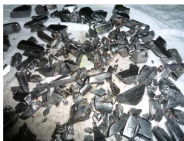
損傷軸受写真 (内輪, 外輪)
