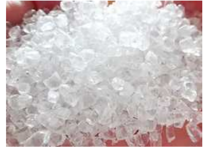
分離したガラス
