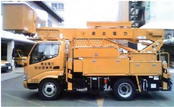
工事中の騒音を低減させるバッテリー駆動型高所作業車
