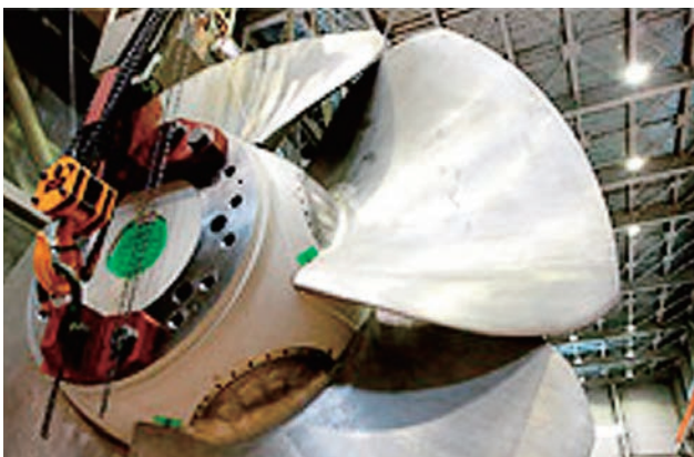
ランナ（水車）の羽根部分を可動式に変更することで水の流量により角度を変え、高効率の発電が可能となりました
