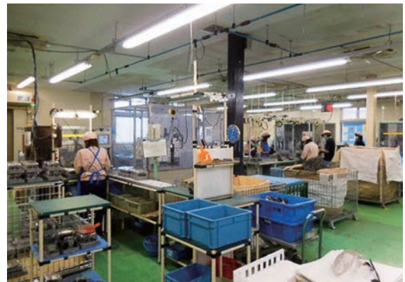
廃却計器分解作業
