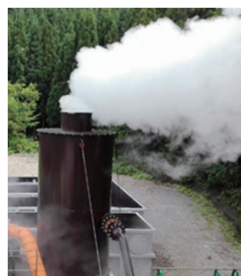
木地山・下の岱地域(秋田県湯沢市)における調査井の仮噴気試験状況
