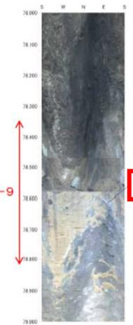
F-9断層破砕部は固結・非固結混在(粘土状, 岩片状, 固結状)
