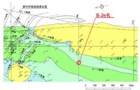
断層位置 試料採取位置 (B-2e孔)
