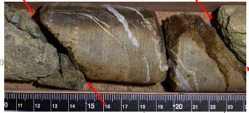
断層面(上盤側) 固結・岩石化したセピオライト 断層面(下盤側)
