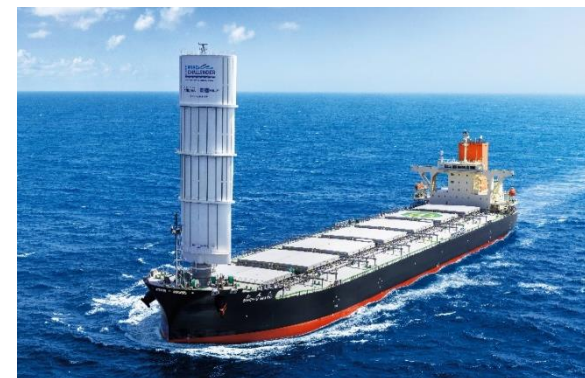
«ウインドチャレンジャー搭載石炭船 松風丸»
