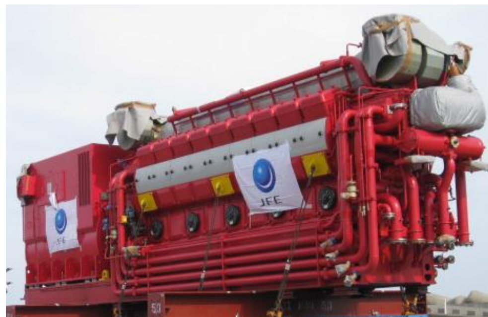
大容量電源設備 エンジン発電機ユニット(据付工事前)
