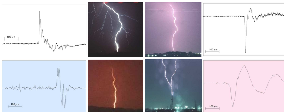
図2 落雷の写真と電波の波形の例（極性と放電の向きにより特徴が異なる）
