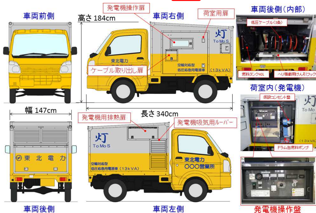
図2 空輸対応型電源車「灯」の概要
