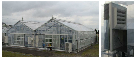
図1 試験設備 左:試験用ハウス 右:ヒートポンプ
