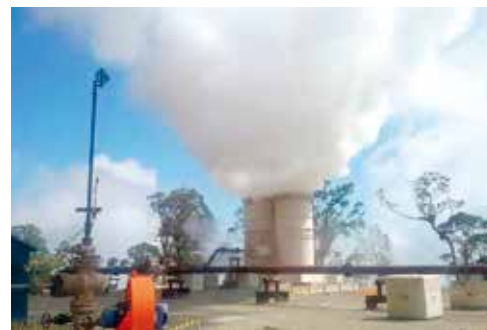
ランタウ・デダップ地熱発電事業開発地点 (蒸気の噴気試験の様子)
