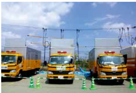
高圧応急用電源車による送電の様子
