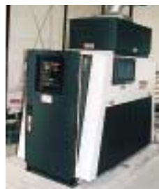
マイクロガスタービン(灯油用,75kW)
