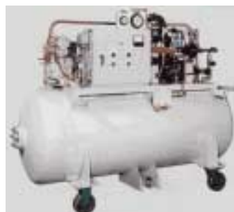
SF 6 ガス回収装置
